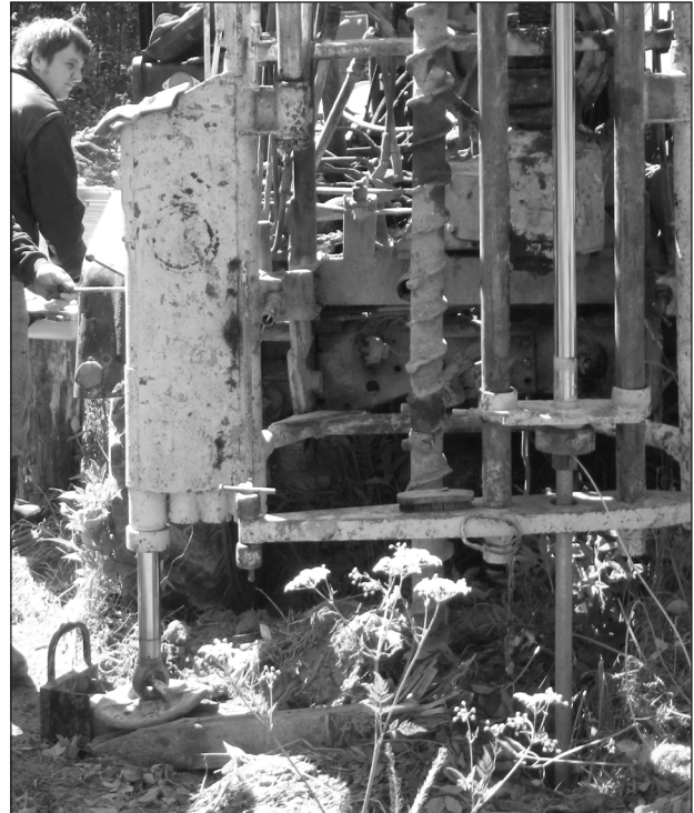
2 pav. Seisminio dilatometro bandymas tyrimų aikštelėje Fig. 2. Seismic dilatometer test (SDMT) at site
